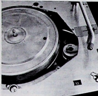
Afb. 7. Aandrijving van de draaitafel van de GA230
